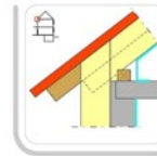
Abb. 2: Prinzip Anschluss Außenwanddämmung an Zwischensparrendämmung
